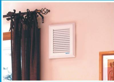
Laite asennetaan makuuhuoneeseen tai muuhun kuivaan tilaan. Laite sijoitetaan ulkoseinälle huoneen yläosaan, laitteen yläreunan etäisyys katosta min. 200 mm. Kiinnitys seinään tapahtuu kiinnityskehiksen avulla. Sähköliitäntä pistorasiaan 5m pitkällä verkkojohdolla. Johdon voi sijoittaa koristelistan taakse koska käyttöjännite on 12 V.
